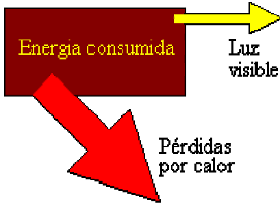
Figura 2.1.2: se muestra el rendimiento de una lámpara incandescente
