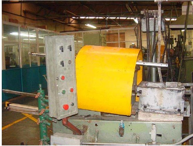
Figura 5.1 Construcción Guarda Protectora.
