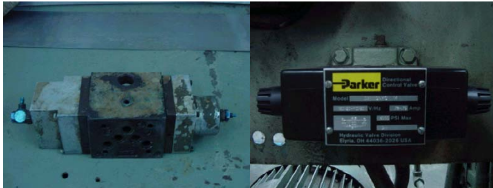
Figura 3.5 Cambio de sistema Neumático a Eléctrico
