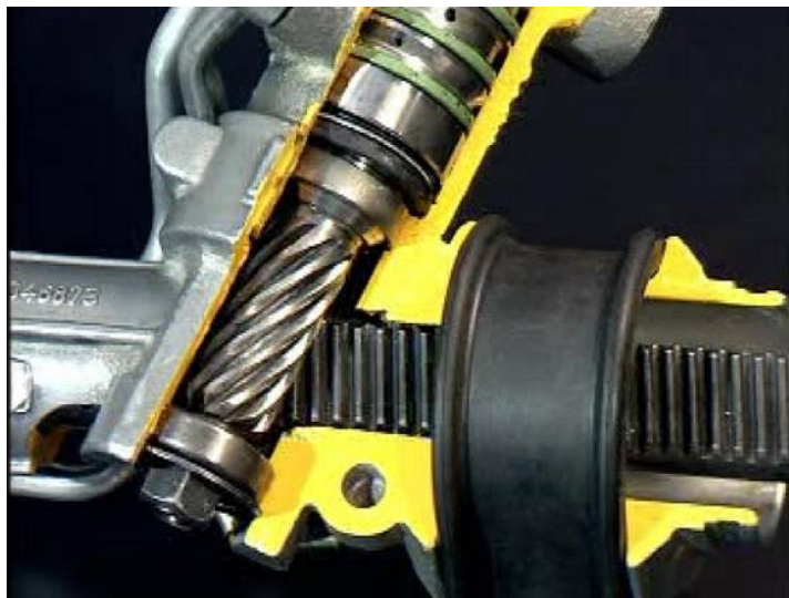
Figura 3.9: Mecanismo de piñón y cremallera (Componentes Automovilísticos S. A., 2005)
