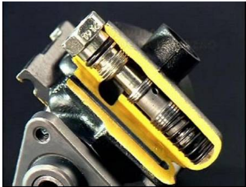
Figura 3.13: Válvula de alivio y válvula de controladora de vacío (Fuente: Componentes Automovilísticos S. A., 2005)
