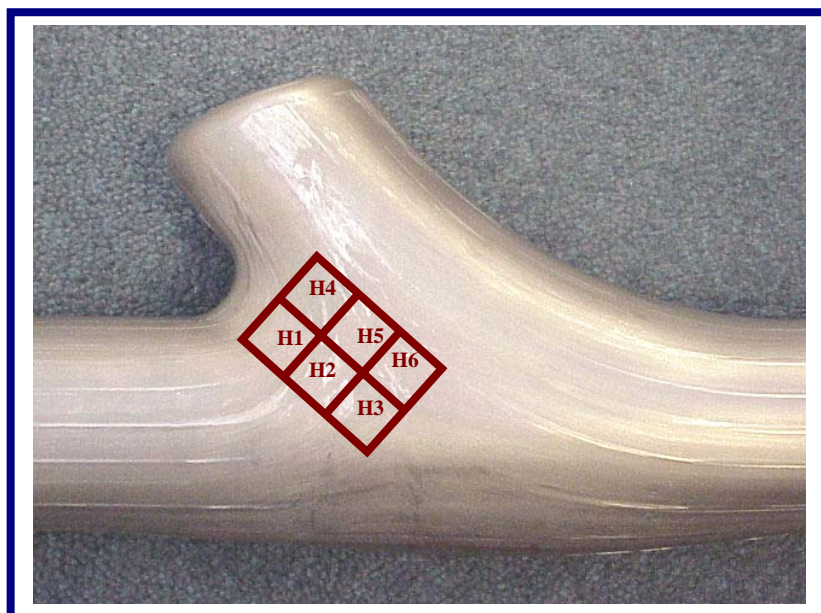
Figura 6.16 Muestra H en pieza Tratada Térmicamente Mostrando Secciones de Corte Utilizadas en Metalografías.
