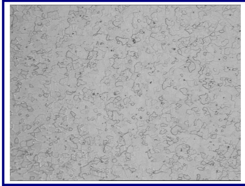
Figura 6.19 Microestructura de Muestra H2 en Sección Transversal.
