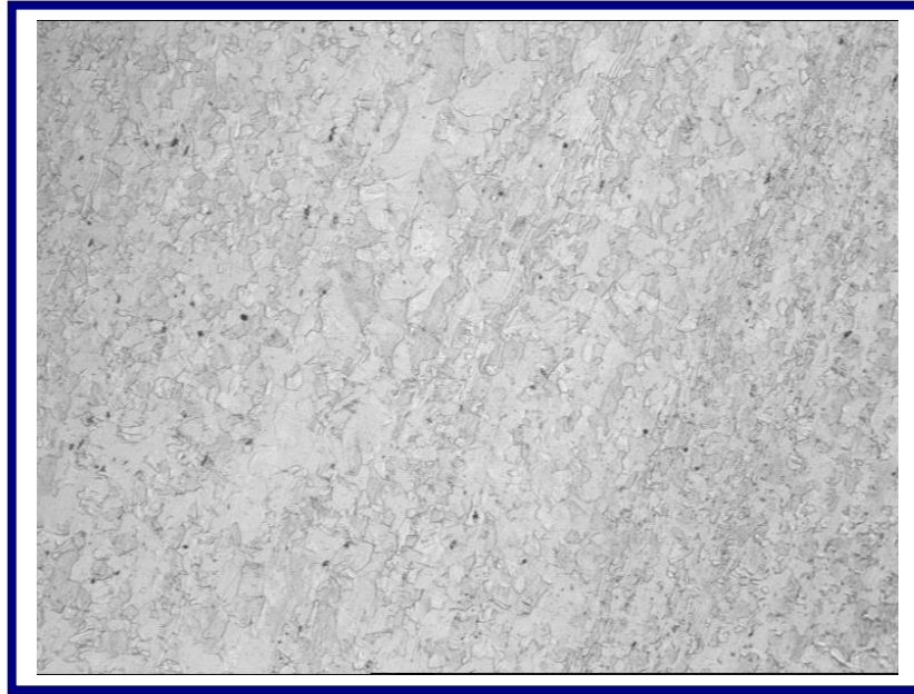
Figura 5.13 Microestructura de Muestra F en Sección Longitudinal. Ataque con Reactivo de Vilella. 100X
