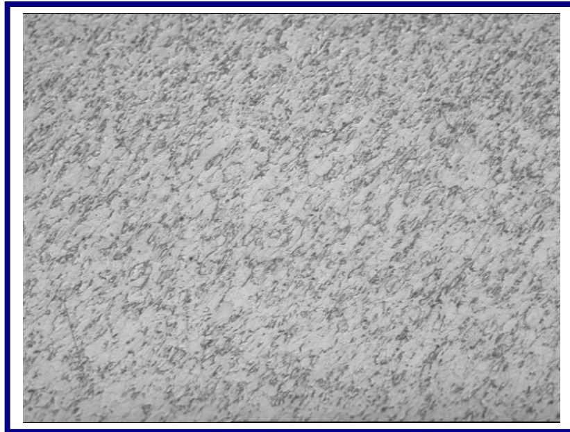
Figura 5.25 Microestructura de Muestra H5 en Sección Transversal. Ataque con Reactivo de Vilella. 100X
