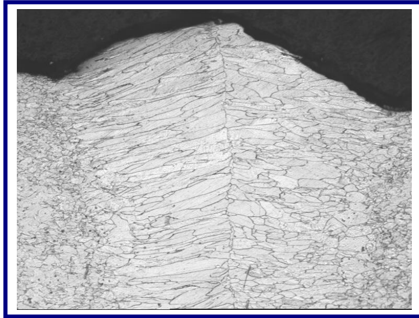
Figura 5.7 Microestructura de Muestra C en Sección Transversal. Ataque con Reactivo de Vilella. 100X
