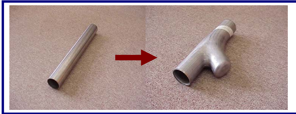
Figura 5.1 Pieza Hidroformada (derecha) a partir del Tubo Rolado y Soldado (izquierda).
