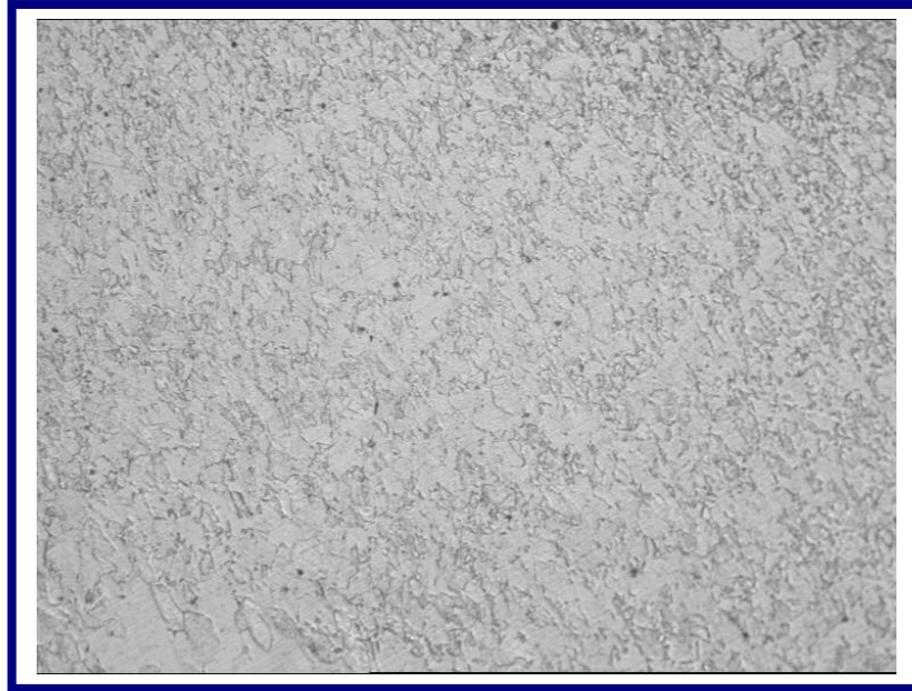
Figura 5.26 Microestructura de Muestra H5 en Sección Longitudinal. Ataque con Reactivo de Vilella. 100X
