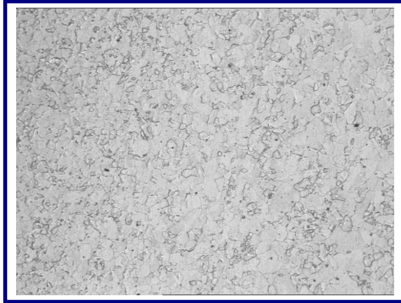
Figura 5.3 Microestructura de Muestra A en Sección Transversal Ataque con Reactivo de Vilella. 100X
