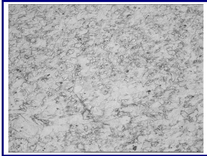
Figura 5.24 Microestructura de Muestra H4 en Sección Longitudinal. Ataque con Reactivo de Vilella. 100X
