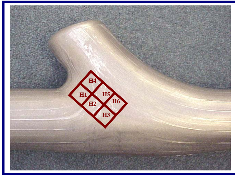
Figura 5.16 Muestra H en Pieza Hidroformada Mostrando Secciones de Corte Utilizadas en Metalografías.
