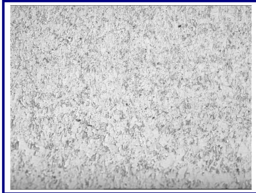
Figura 5.21 Microestructura de Muestra H3 en Sección Transversal. Ataque con Reactivo de Vilella. 100X
