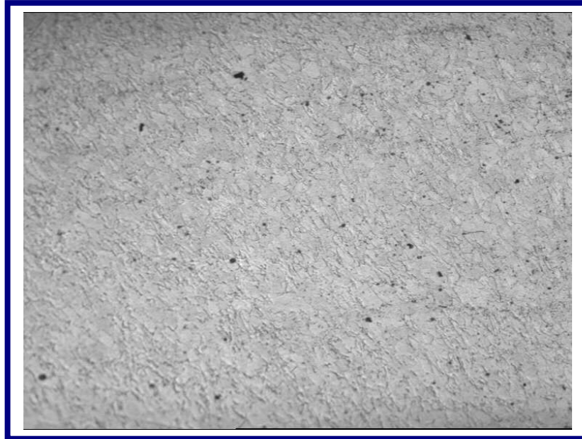
Figura 5.28 Microestructura de Muestra H6 en Sección Longitudinal. Ataque con Reactivo de Vilella. 100X
