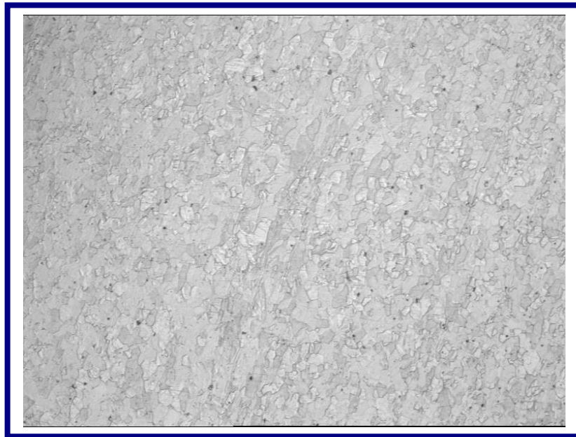
Figura 5.12 Microestructura de Muestra F en Sección Transversal. Ataque con Reactivo de Vilella. 100X
