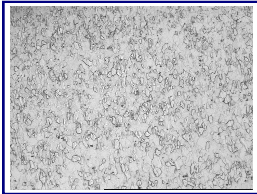
Figura 5.10 Microestructura de Muestra D en Sección Longitudinal. Ataque con Reactivo de Vilella. 100X
