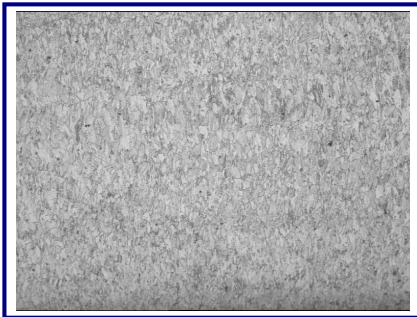
Figura 5.19 Microestructura de Muestra H2 en Sección Transversal. Ataque con Reactivo de Vilella. 100X
