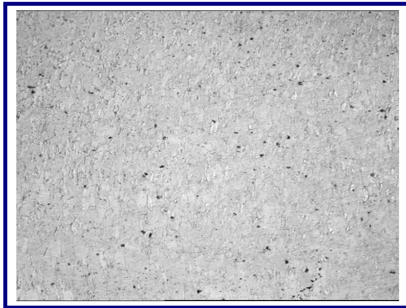
Figura 5.27 Microestructura de Muestra H6 en Sección Transversal. Ataque con Reactivo de Vilella. 100X
