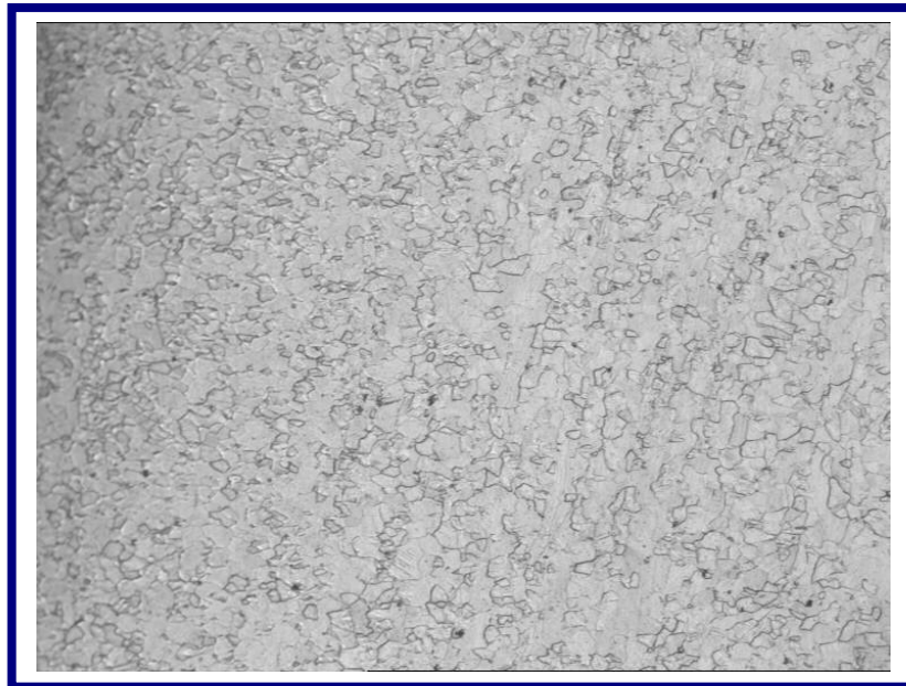
Figura 5.4 Microestructura de Muestra A Sección Longitudinal. Ataque con Reactivo de Vilella. 100X
