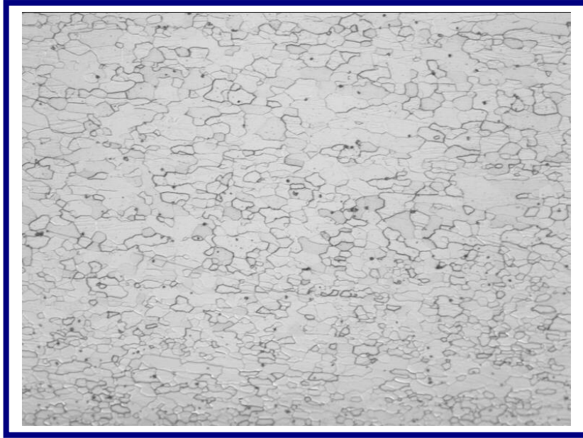
Figura 4.3 Microestructura de Muestra R2 en Sección Longitudinal Ataque con Reactivo de Vilella. 100X
