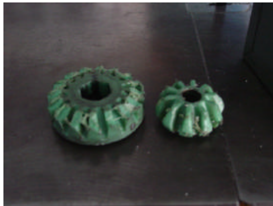
Figura 6. 10 Engranes dañados por falta de ajuste en la caja diferencial
