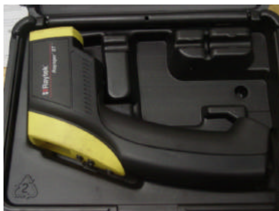
Figura 6. 12 Termómetro láser para medición de temperatura.
