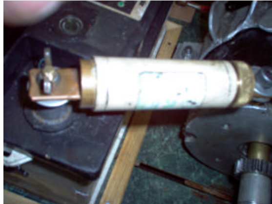
Figura 6.6 Fusible de 100 Amperes para protección del motor.
