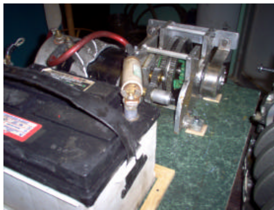
Figura 6.5 Sistema de potencia con batería colocado en el banco de pruebas.
