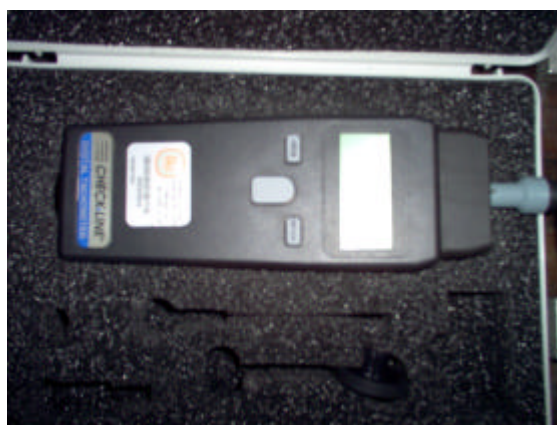
Figura 6.4 Tacómetro digital para medición de RPM de entrada.
