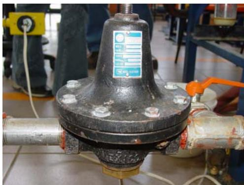
Figura 7.19 Válvula de estrangulamiento
