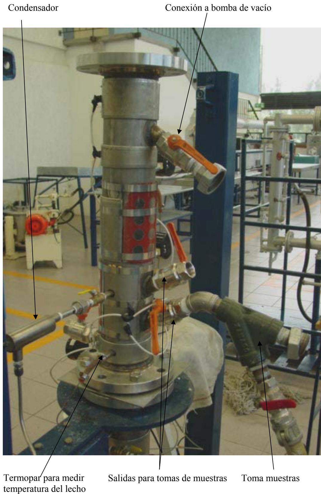
Figura 7.27 Elementos de la parte posterior
