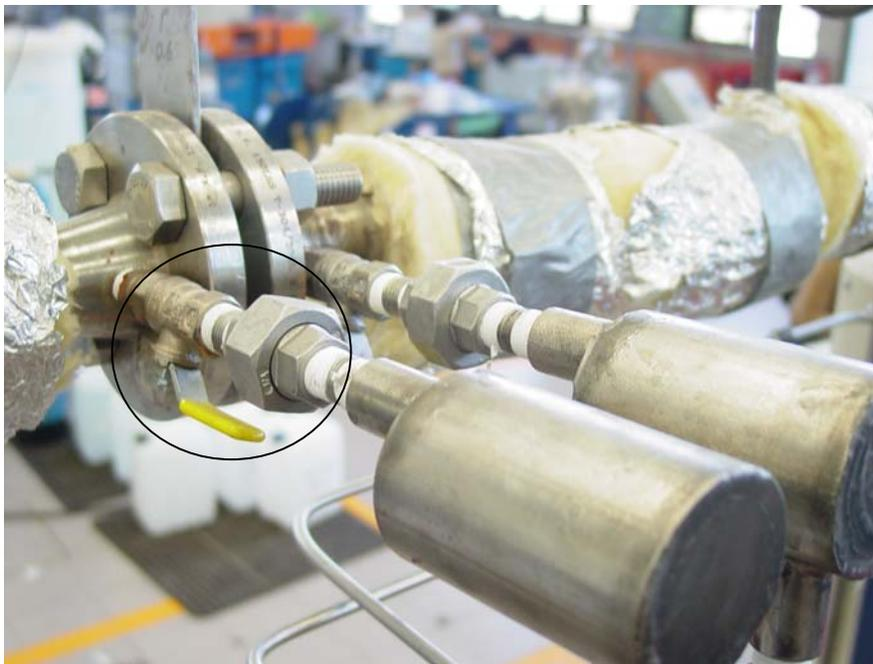
Figura 7.13 Tomas de brida y condensadores. Se muestra en el círculo las válvulas de bola que sirven para proteger a los manómetros de exceso de presión.
