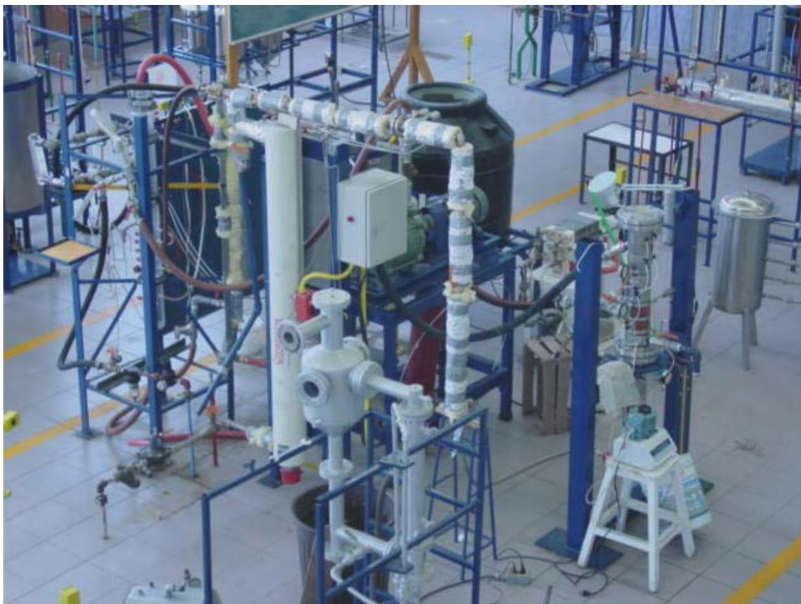
Figura 7.28 Sistemas integrados: columna de fluidización de vidrio (a la izquierda) y columna de fluidización de acero inoxidable (a la derecha)
