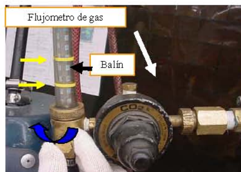
Figura 2.18.- Perilla de flujómetro de mezcla de gas. Balín debe estar dentro del rango del flujo establecido (marcas amarillas)
