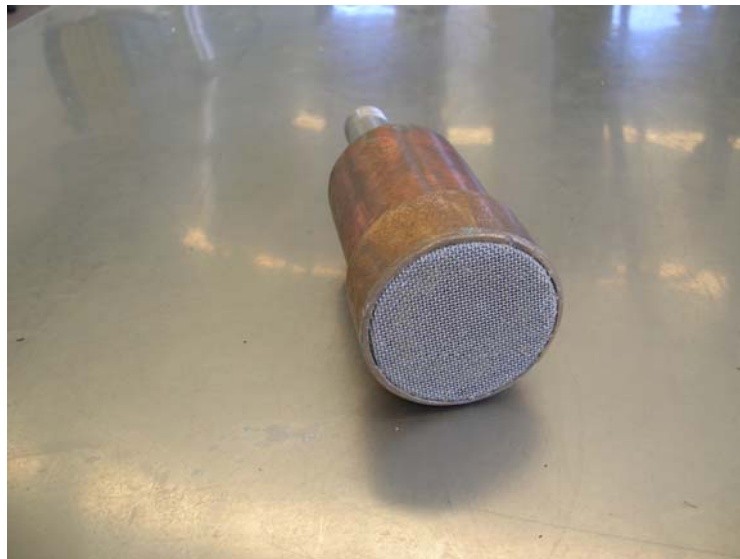
Figura H.1 Filtro para la manguera que toma agua del intercambiador
