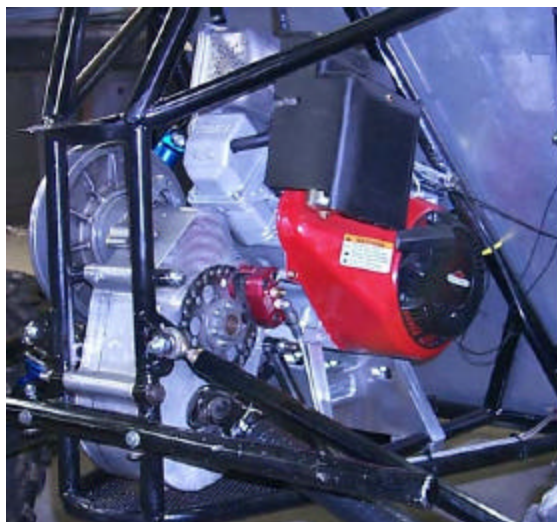
Figura 6. 2 Estructura que Soporta la Fuente de Poder (Briggs & Stratton 10 HP OHV Intek Modelo 205432).
