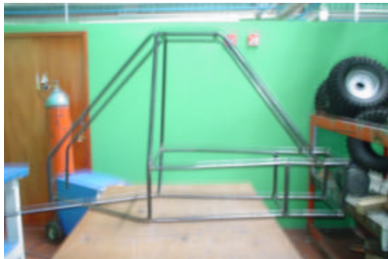
Figura 6. 20 Vista Lateral de la Estructura Tubular.
