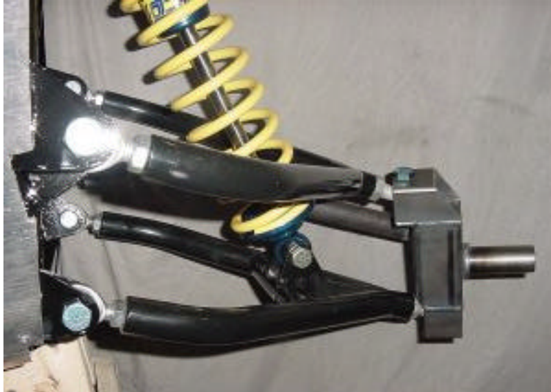
Figura 6. 3 Estructura que Soporta la Suspensión del automóvil.
