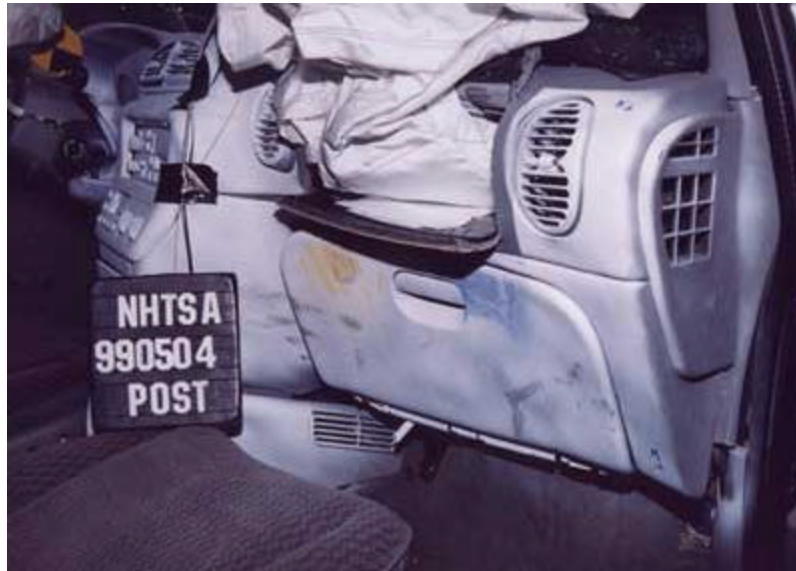
Figura A. 13 Las rodillas del maniquí delantero del copiloto golpearon el tablero de instrumentos durante el impacto. También, observe que nada del compartimiento del reactor penetró la cabina. El motor en la mayoría de los coches se monta para un impacto, forzarlo al revés y hacia abajo de modo que no venga en la cabina.
