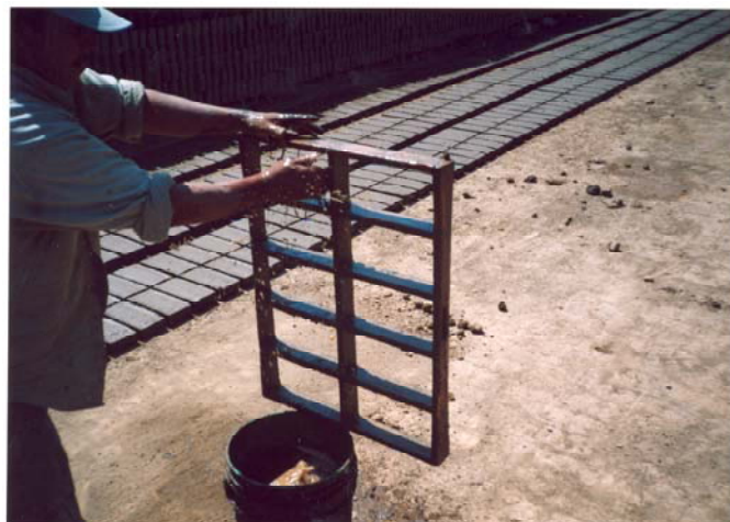
Figura 19. Limpieza de la rejilla.
