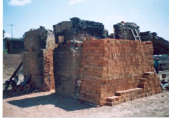
Figura 15. Estiba de ladrillo cocido.
