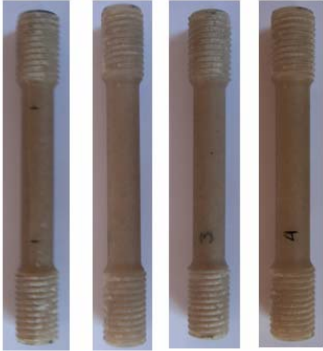
Figura 5.1 Probetas de tensión con longitud de fibra de 2.4 cm.
