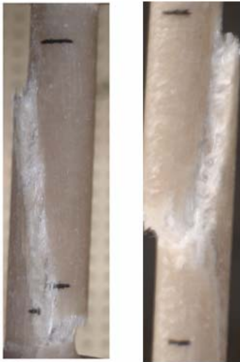
Figura 5.1.1 Fractura de probetas con longitud de fibra de 2.4 cm.
