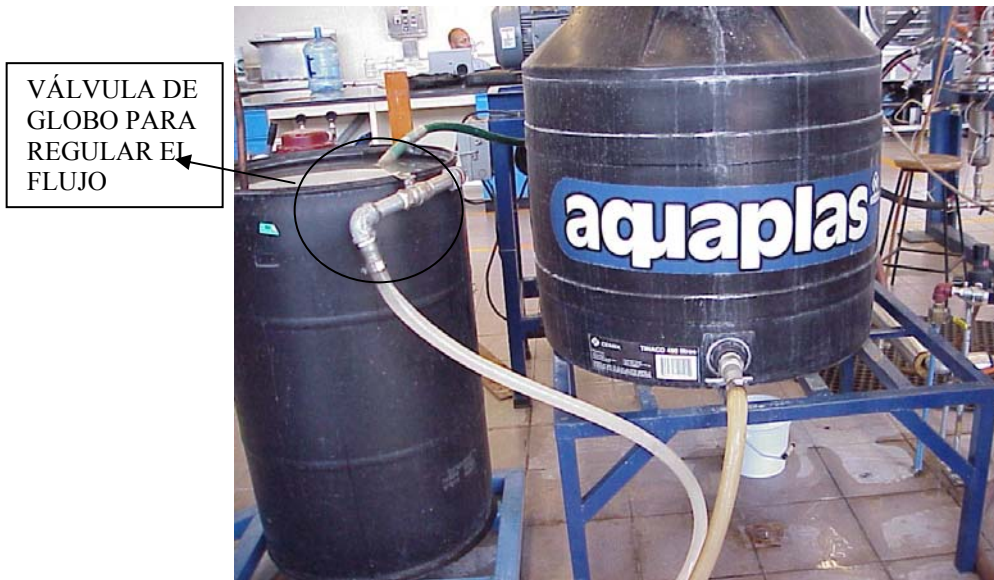
FIGURA 5.2 Conexión entre tanques para facilitar enfriamiento
