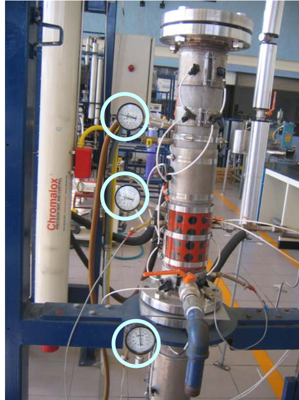
Figuras 4.15: Se observan los 3 manovacúómetros instalados a lo largo de la columna
