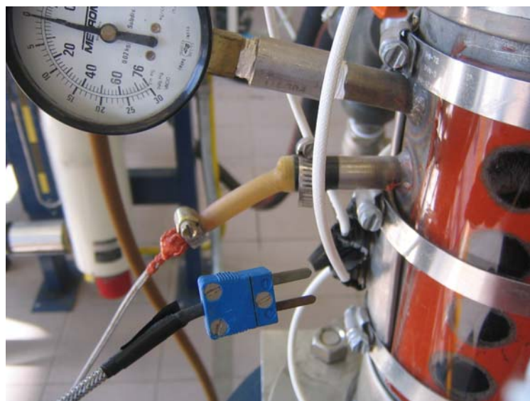
Figuras 4.16. Uno de los tres termopares a los largo de la columna de fluidización.
