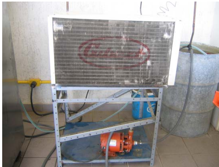
Figura 4.19. Equipo de enfriamiento que contiene el serpentín de calor
