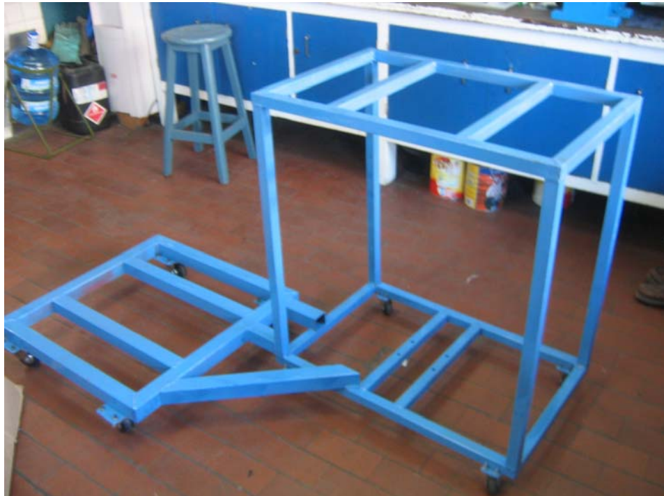
Figura 4.21 Transporte para equipo de enfriamiento del agua usada en los experimentos de fluidización.
