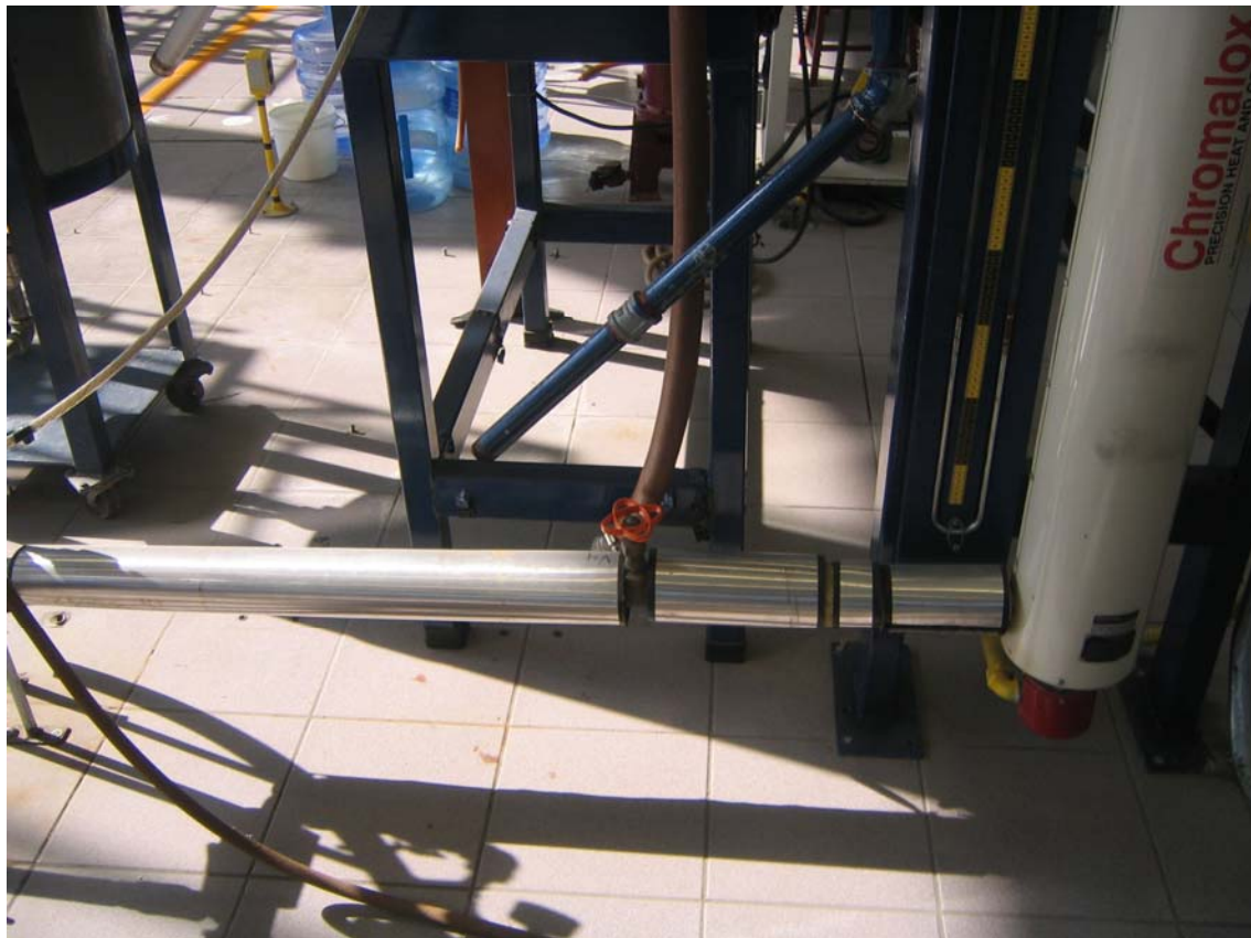
Figura 4.4. Válvula de globo para nivelar el flujo de vapor que se dirige hacia el calentador. [13]
