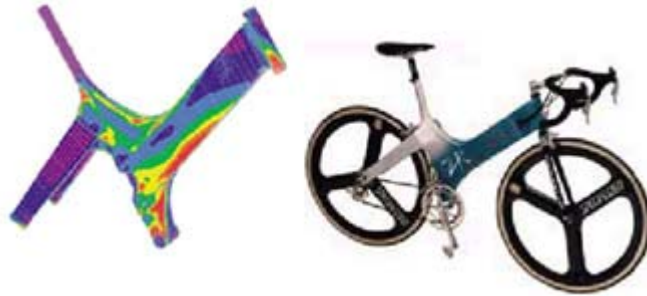
Figura 0.4 Bicicleta modelada en sólido con análisis en ALGOR.
