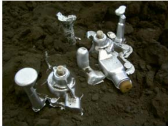
Fig. 4.1 Cascos de aluminio recién desmoldeados.
