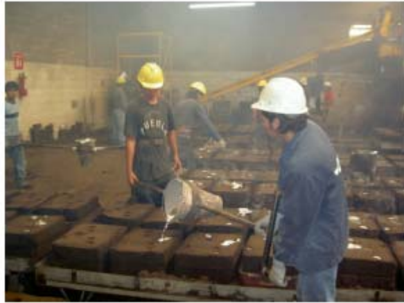
Fig. 2.2 Vaciado del aluminio fundido en los moldes.
