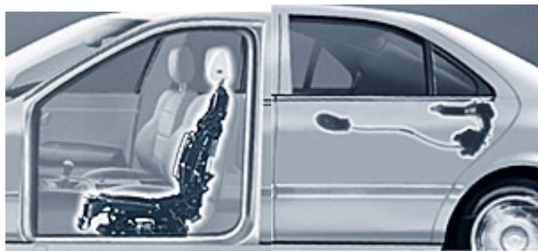
Fig. N° 3.4: Sistemas de puertas y reguladores de ventanas hechos por Brose
