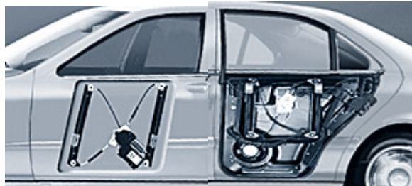
Fig. N° 3.4: Sistemas de puertas y reguladores de ventanas hechos por Brose
