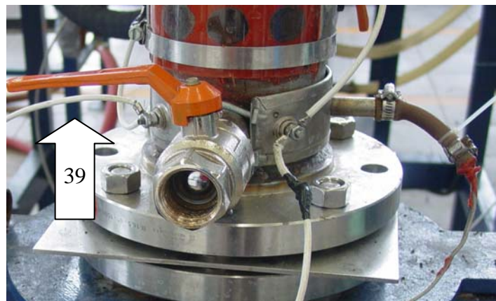
Figura 7.9 Válvula de seguridad para operar la bomba de vacío.
