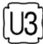
Fig. 9.10 Estampa ASME para los Generadores de la División III.
