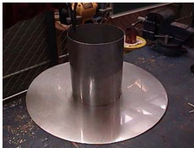
Fig. 6.2 Chimenea con base.
