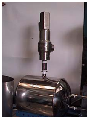
Fig. 6.16 Válvula de Seguridad.
