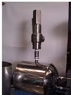
Fig. 4.2 Válvula de Seguridad.
