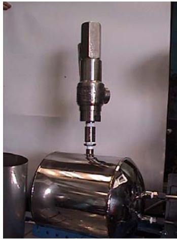
Fig. 10.18 Válvula de seguridad.
