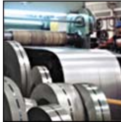
Figura 2.4.2 Corte en Slitter
