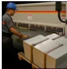
Figura 2.4.3 Corte en Cizalla
