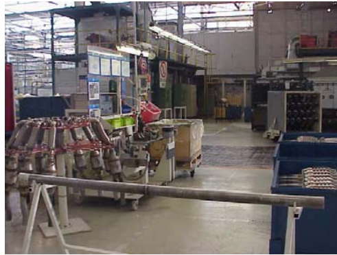
Figura 4.10. Estación para prueba de hermeticidad y fijación de coraza
