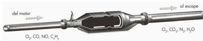
Figura 2.12. Gases transformados por el convertidor catalítico
