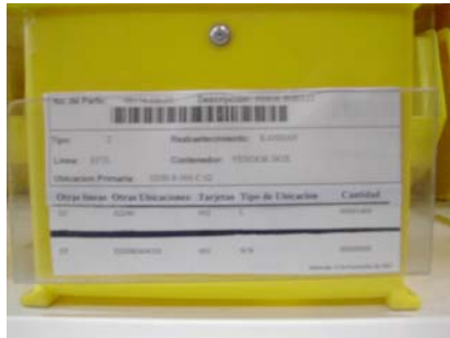
Figura 3.20 Mica remachada al contenedor de plástico
