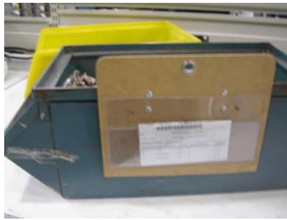
Figura 3.21 Mica remachada a la tabla con pinza
