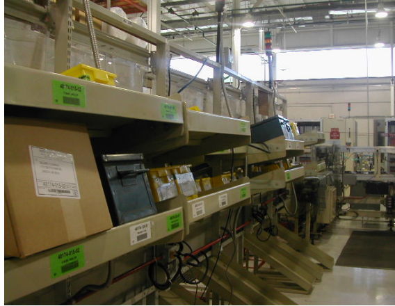
Figura 3.23 Inclinación de rampas
