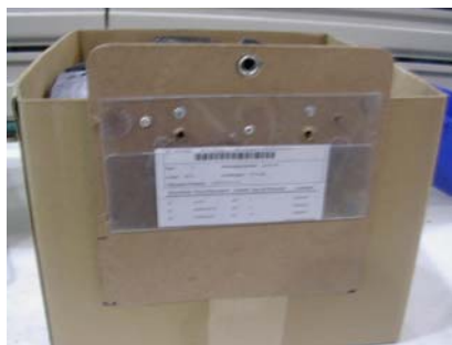
Figura 3.22 Mica remachada a la tabla con pinza
