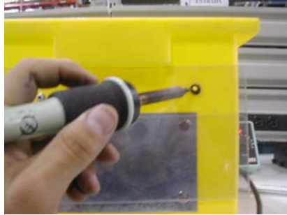
Figura 3.19 Perforación del contenedor
