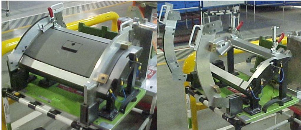
Figura 4.2. Dispositivo para medir el torcimiento de la tapa de la guanterera.
