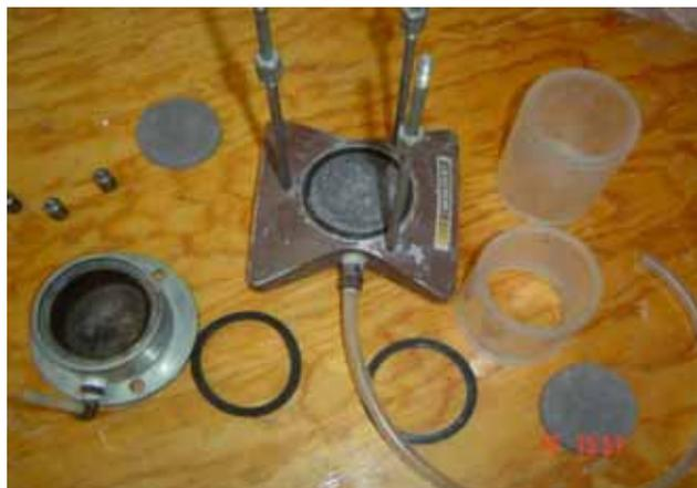
**Figura.5.6 Permeámetro de carga variable**
