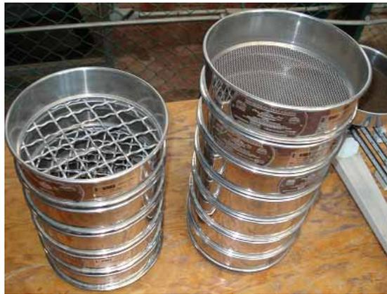
**Figura 5.4. Juego de mallas para determinar la granulometría del suelo.**
