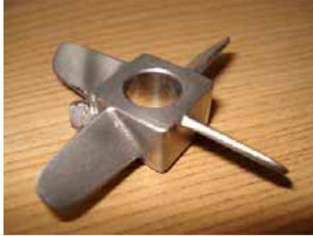
***Figura.5.2. Impulsor A200, con Cuatro Paletas Inclinas a 45°.***
