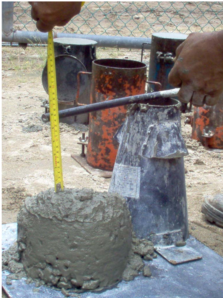
Figura 3.11 Prueba de revenimiento.
