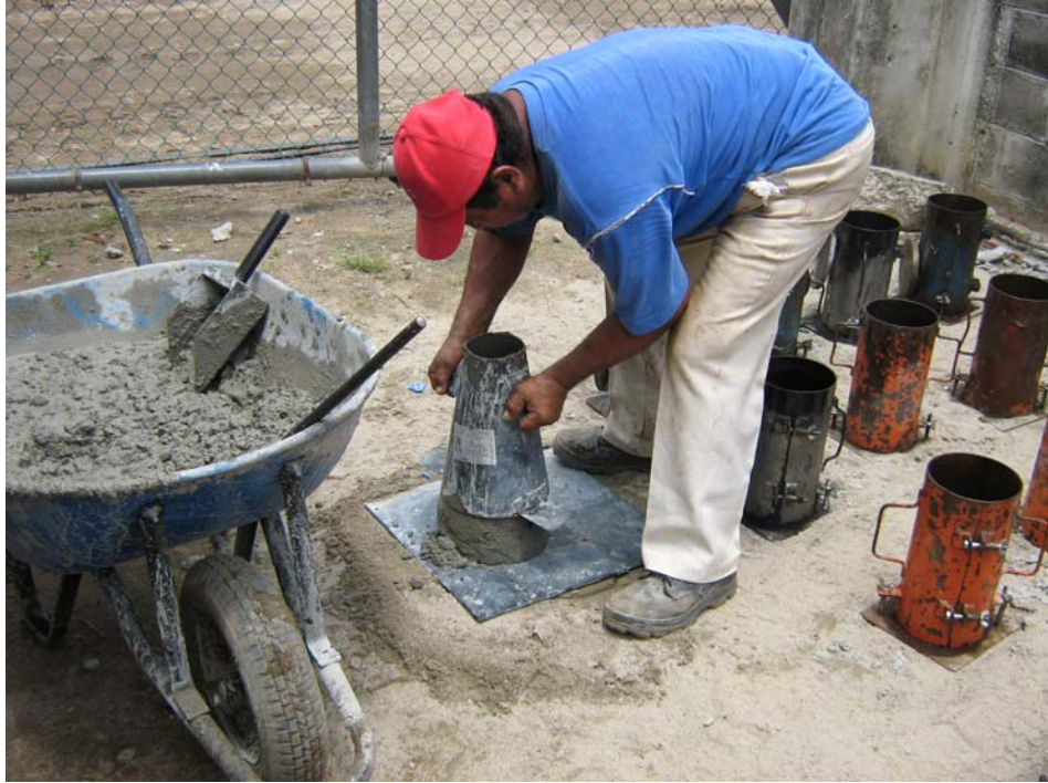
Figura 3.38 Prueba de revenimiento.
