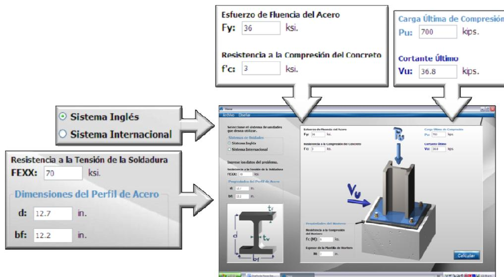
Figura 5.12 Ventana de Ingreso de Datos - Placas Base para Columnas con Carga Axial y Cortante Resistido con Diafragma de Acero
