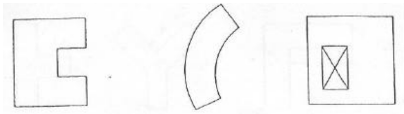
Figura 6.1.1.1 Formas asimétricas en planta indeseables [Bazán, E., Meli, R. (2002)]
