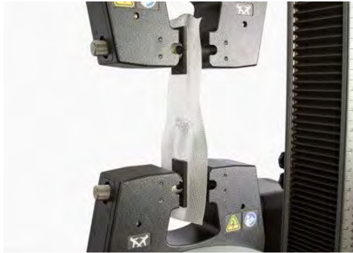
Figura 17.- Ensayo a Tensión Grab (Instron, 2021).
