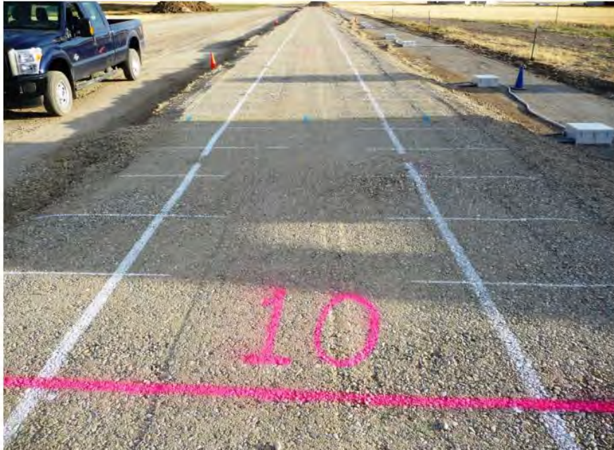
Figura 52.- Fotografía en la sección 10 con aproximadamente cero pulgadas de deformación permanente o rodadura (Cuelho E., Perkins S. & Morris Z., 2014).
