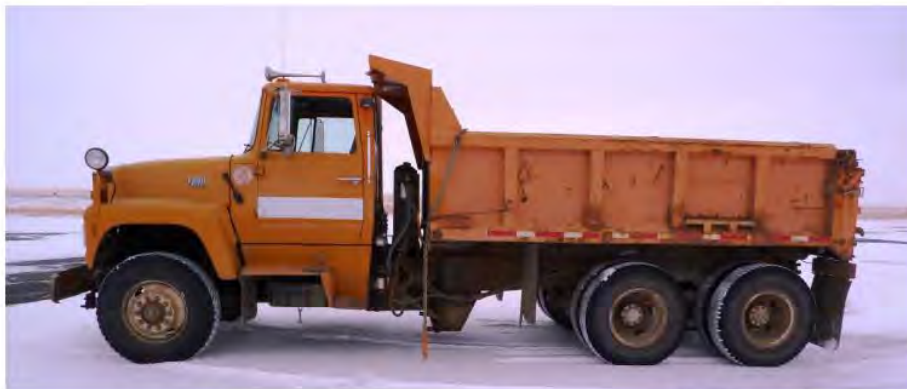
Figura 50.- Camión empleado para vehículo de prueba para el tráfico (Cuelho E., Perkins S. & Morris Z., 2014).
