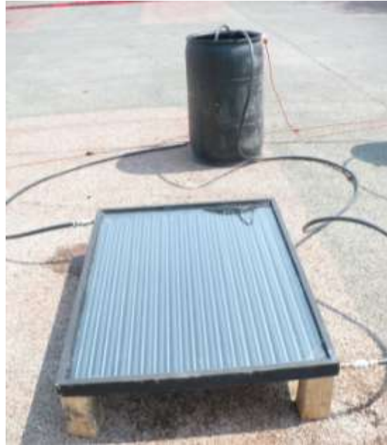
Figura 23. Vista del sistema de concentración solar en V construido.
