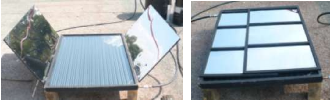
Figura 28. Imagen del colector solar en V mejorado. Fuente propia
