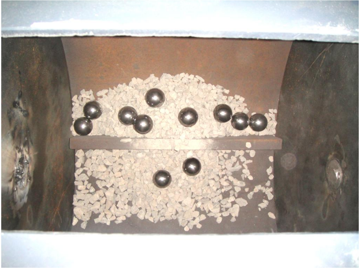
Fotografía 3.- Composición tipo B introducida en la máquina
