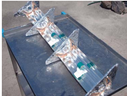
Figura 3.6 Detalle de concentrador parabólico empleado para elaboración de pruebas de desinfección a escala de banco (IMTA, 2006).
