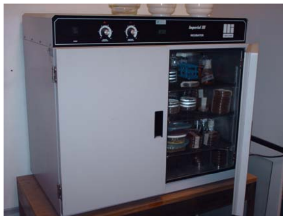
Figura 2.1 Detalle de Incubadora utilizada para la preparación de microorganismos y su análisis de viabilidad.
