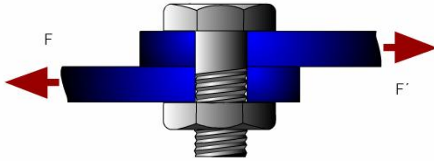
Figura 2.8 Tornillo sujeto a fuerzas cortantes
