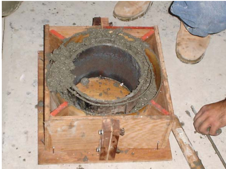
Fig. 4.1 Especimen Reforzado con Malla Electrosoldada.
