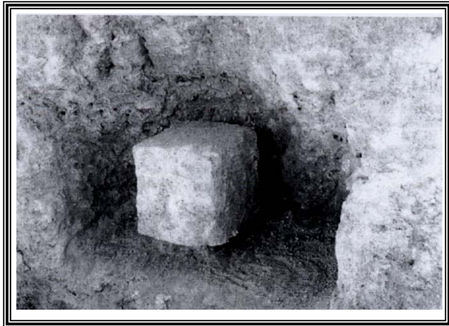
Figura 11.-Obtención de una muestra cúbica inalterada.
