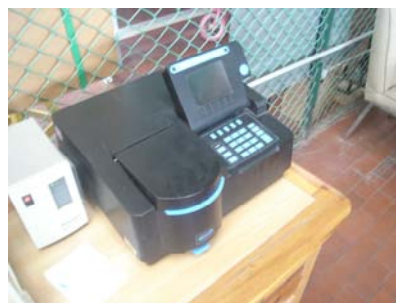
Figura 3.20 Celda de 10 mL y espectrofotómetro para medir concentración de cloro.
