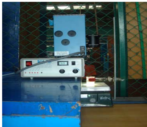
Figura 3.1 Arreglo experimental utilizado para pruebas de desinfección con radiación solar simulada.
