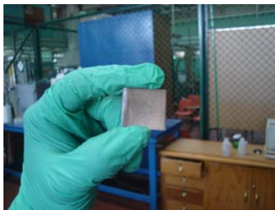
Figura 3.15 Placa recortada de dióxido de titanio.
