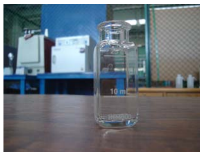
Figura 3.20 Celda de 10 mL y espectrofotómetro para medir concentración de cloro.
