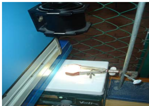
Figura 3.16 Vaso-Reactor bajo el haz de luz producido por el Simulador Solar.
