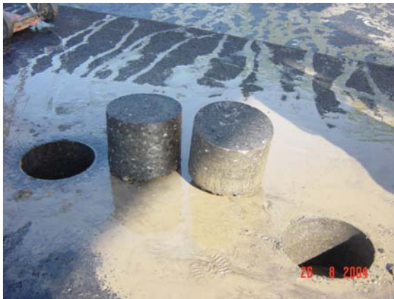
Figura 4.3.5 Proceso de Extracción y Prueba de Núcleos para prueba de Hamburgo
