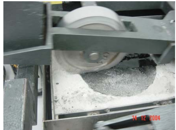
Figura 4.3.5 Proceso de Extracción y Prueba de Núcleos para prueba de Hamburgo
