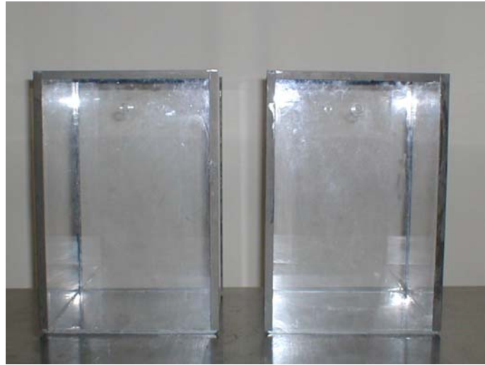
Figura E.3. Reactores Aerobios
