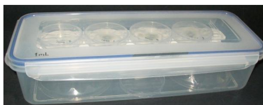
Figura 6. Sistema cerrado herméticamente para generación de vapores
