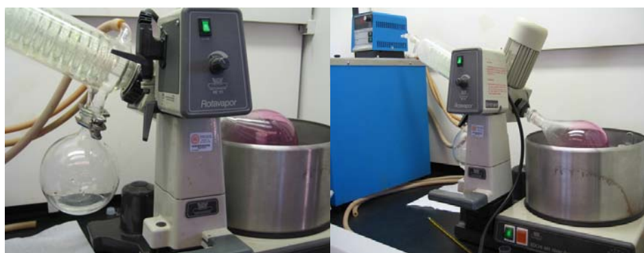
Fig. 7. Rotavapor R – 111 y baño marca Büchi utilizados en la concentración.
