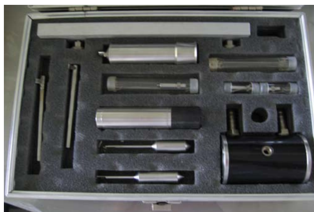
Fig. 3. Aditamentos del adaptador para muestra pequeña.
