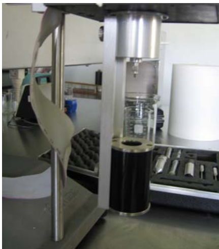
Fig. 4. Modo de fijar el adaptador para muestra pequeña al viscosímetro.
