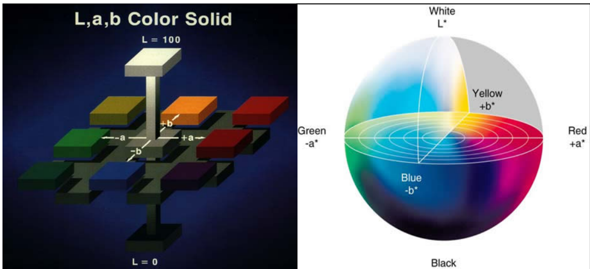
Fig. 1. Sólidos de color para las escalas L, a, b y CIELab.
