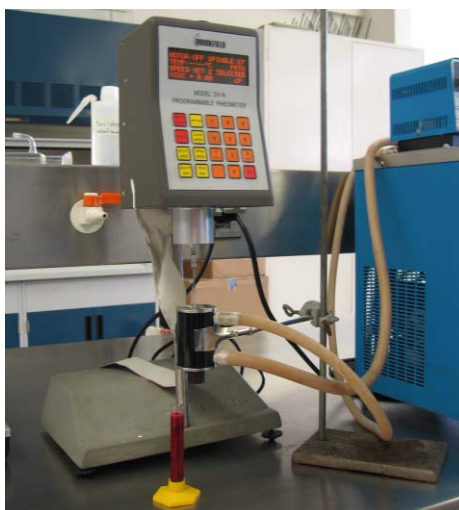
Fig. 5. Conexión entre el recirculador y la chaqueta del adaptador para muestra pequeña.
