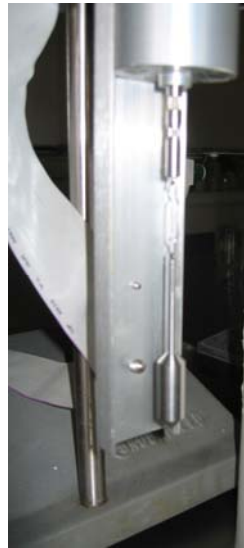
Fig. 6. Modo de instalar la aguja al viscosímetro.
